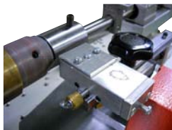
ハンドプレス機 (ギア式) (長脚・真空装置付き) 全高 ..... 1400mm 全幅 ..... 450mm 奥行 ..... 580mm 最大治具載せ面積 ..... 190mm × 320mm Z方向ストローク ..... 0 ~ 120mm 機械重量 ..... 約 27kg 加圧力 ..... 約 180kg ハンドプレスで抜いたものが真空装置によりハンドプレス下部のネットに収集され、静電気でピンや治具裏面等に付着することを防止します。
